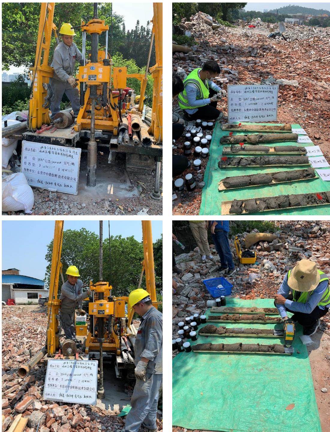
图 5-1 土壤样品现场采集照片
